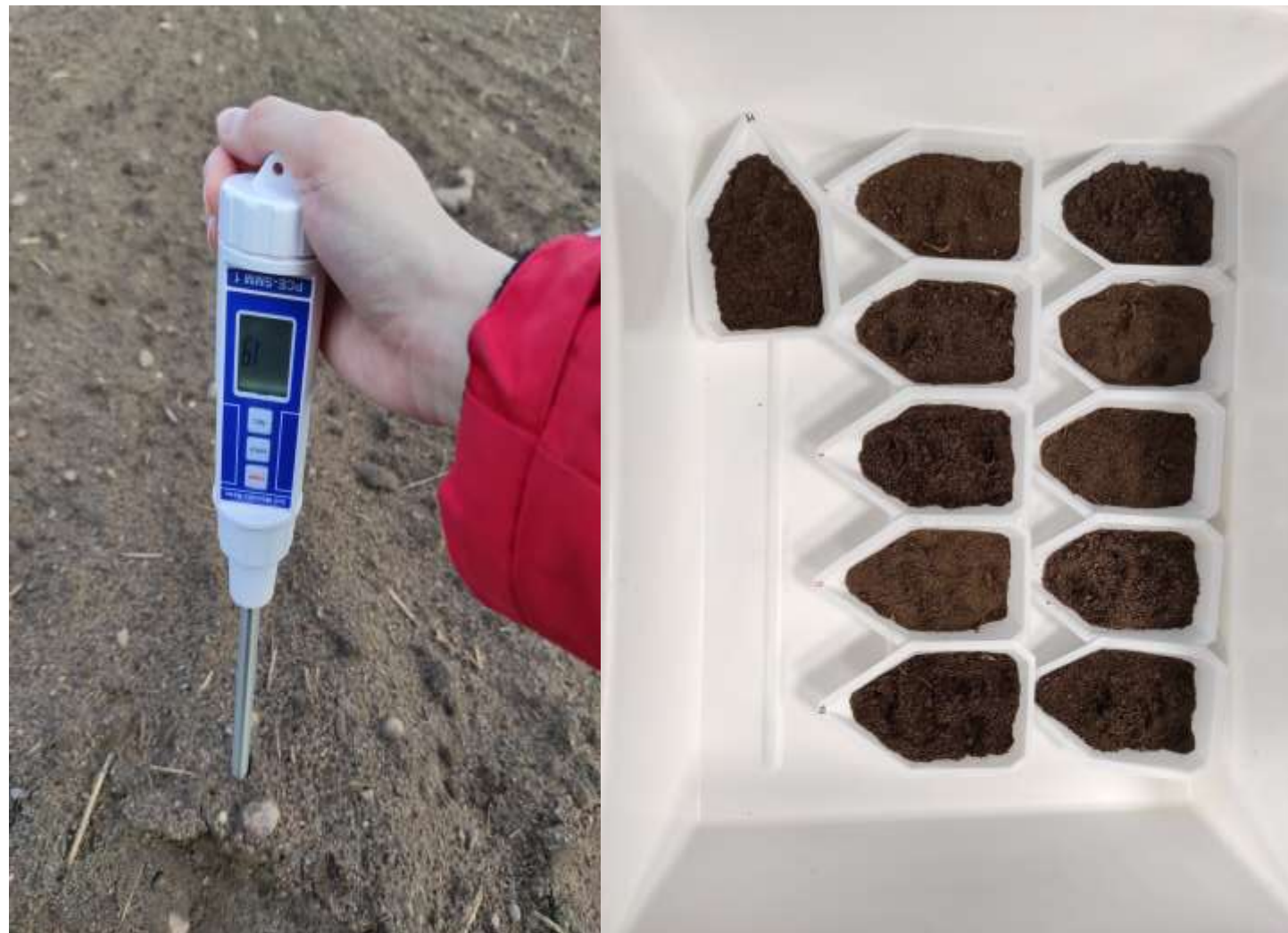
5 pav. Drėgmės nustatymas PCE SMM-1 prietaisu ir gravimetriniu metodu.
